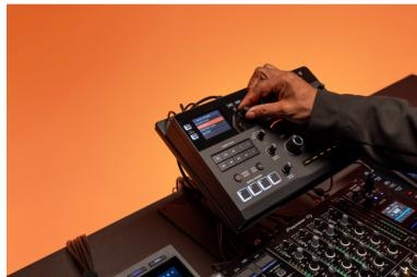
DSP 96 kHz / 64?bit, convertitori **ESS Technology 32?bit A/D e D/A**, architettura audio totalmente riprogettata: il risultato è un suono **naturale, pulito e ad altissima risoluzione**
