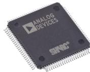
Al cuore delle capacità di trattamento audio del sistema si trova un potente motore di elaborazione digitale del segnale (DSP) basato su processori SHARC di Analog Devices. Questi chipset DSP offrono prestazioni elevate, con velocità fino a centinaia di milioni di istruzioni al secondo, e supportano il calcolo in virgola mobile a 32 bit e 40 bit, garantendo un livello di accuratezza estremamente elevato e una riproduzione sonora ricca di dettaglio, ideale per applicazioni audio professionali.
