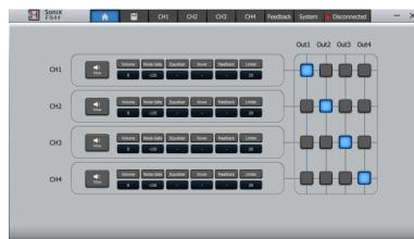
SoniX FS44 è basato su un processore **SHARC** di quarta generazione da 450 MHz/32 bit. La conversione AD/DA è a 24 bit con frequenza di campionamento di 96 kHz. Ogni canale è dotato di Phantom a 48V, Noise Gate, equalizzatore grafico a 6 bande, filtro passa-alto e filtro passa-basso, correzione automatica dello spostamento di fase/frequenza e limitatore.
