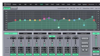
Per le 8 uscite, oltre ai normali controlli di livello, mute, fase, raggruppamento, assegnazione ed equalizzatore multibanda presenti sugli ingressi, sono presenti l'equalizzatore a 15 bande più HPF e LPF, i filtri IIR (Infinite Impulse Response) e FIR, nonché l'intera sezione di controllo della dinamica con compressore e limitatore.
