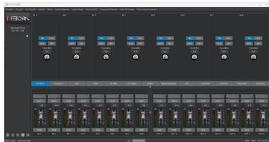
Tutte le funzioni sono controllabili tramite software per sistemi Windows® (USB e TCP/IP) con un'interfaccia minimale, funzionale e intuitiva che consente la programmazione di una notevole quantità di funzioni di elaborazione in pochi minuti.
