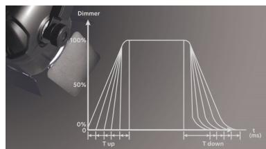
Il processore digitale permette di scegliere 5 curve di risposta ai controlli di dimmer via DMX-512. Questo consente di adattare il faro a esigenze applicative differenti.
