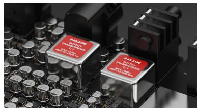
I trasformatori audio da studio all'uscita principale (1L/2R) forniscono caratteristiche sonore calde e garantiscono l'isolamento elettrico per evitare interferenze da loop di massa.
