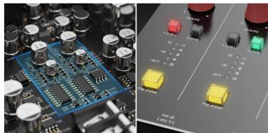
Utilizzando il circuito di compressione 76PRE di tipo FET, impiega circuiti hardware puri per una migliore qualità timbrica e offre molteplici modalità preimpostate attraverso il controllo digitale per varie applicazioni. Il canale d'ingresso utilizza transistor discreti di Classe A pura ad alta dinamica, raggiungendo un guadagno massimo di 71 dB. Ciascun canale di ingresso è dotato di una modalità boost integrata e di 4 diverse modalità di compressione.
