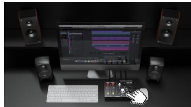
Modalità A/B: In questa modalità, è possibile collegare simultaneamente 4 diffusori monitor attivi alle uscite (1L/2R e 3L/4R) e commutare il monitoraggio con un solo clic premendo il tasto (OUT 3/4).
