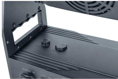
Realizzato in alluminio pressofuso con grado di protezione IP65, il **MoodWave Pro 24** è progettato per resistere alle condizioni più estreme (-40°C a 45°C). Il rivestimento anti-UV e anti-corrosione garantisce durata e performance affidabili sia in ambienti interni che esterni, rendendolo ideale per eventi, spettacoli e installazioni permanenti.
